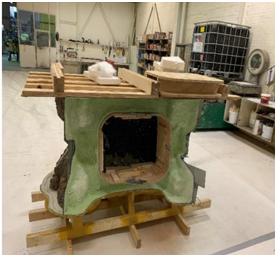
Die Gußform mit der letzten Silikonschicht, die im Anschluss polyestert wurde.
